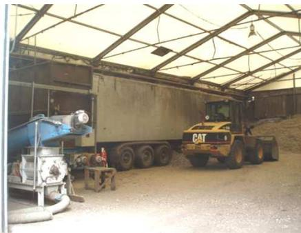
Die Zuführung der Sekundärbrennstoffe erfolgt über einen stationär installierten walking floor. Über mechanische Fördereinrichtungen wird der Sekundärbrennstoff zu einem Injektor gefördert und von dort über eine ca. 150 m lange Leitung pneumatisch den Brennern zugeführt (Abb. 6). Die Annahme, hiermit einen erheblichen Teil der Primärenergie Kohle zu ersetzen, hat sich leider nicht bestätigt.
