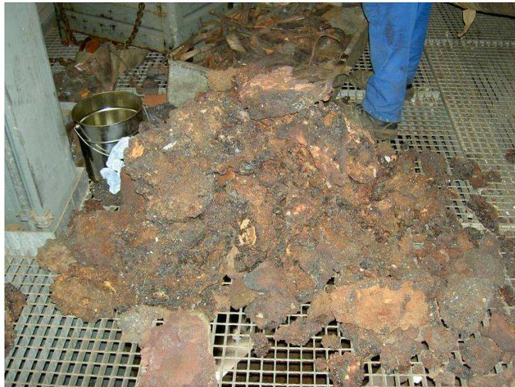
**Bild 9: Verkrustungen im Wirbelbett aufgrund von Ablagerungen und ungleichmäßiger Temperaturverteilung**
