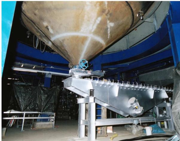
**Bild 6: Austrag aus offenem Düsenboden**
