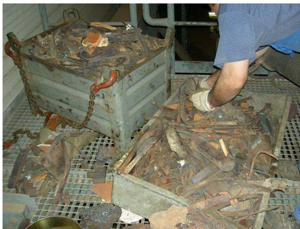
**Bild 7: Störstoffe aus dem Wirbelbett aus Ersatzbrennstoffen**
